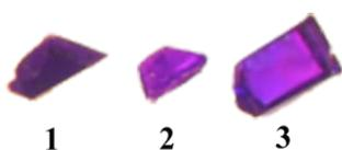
**Figure 7.** Optical images of single crystals of  $K_2[(VO)_2(C_4H_2O_6)_2(H_2O)_2] \cdot (H_2O)_2$ , **1**,  $Rb_2[(VO)_2(C_4H_2O_6)_2(H_2O)_2] \cdot (H_2O)_2$ , **2**, and  $Cs_2[(VO)_2(C_4H_2O_6)_2(H_2O)_2] \cdot (H_2O)_2$ , **3**. Crystals are  $\sim 0.75$  mm in length.
